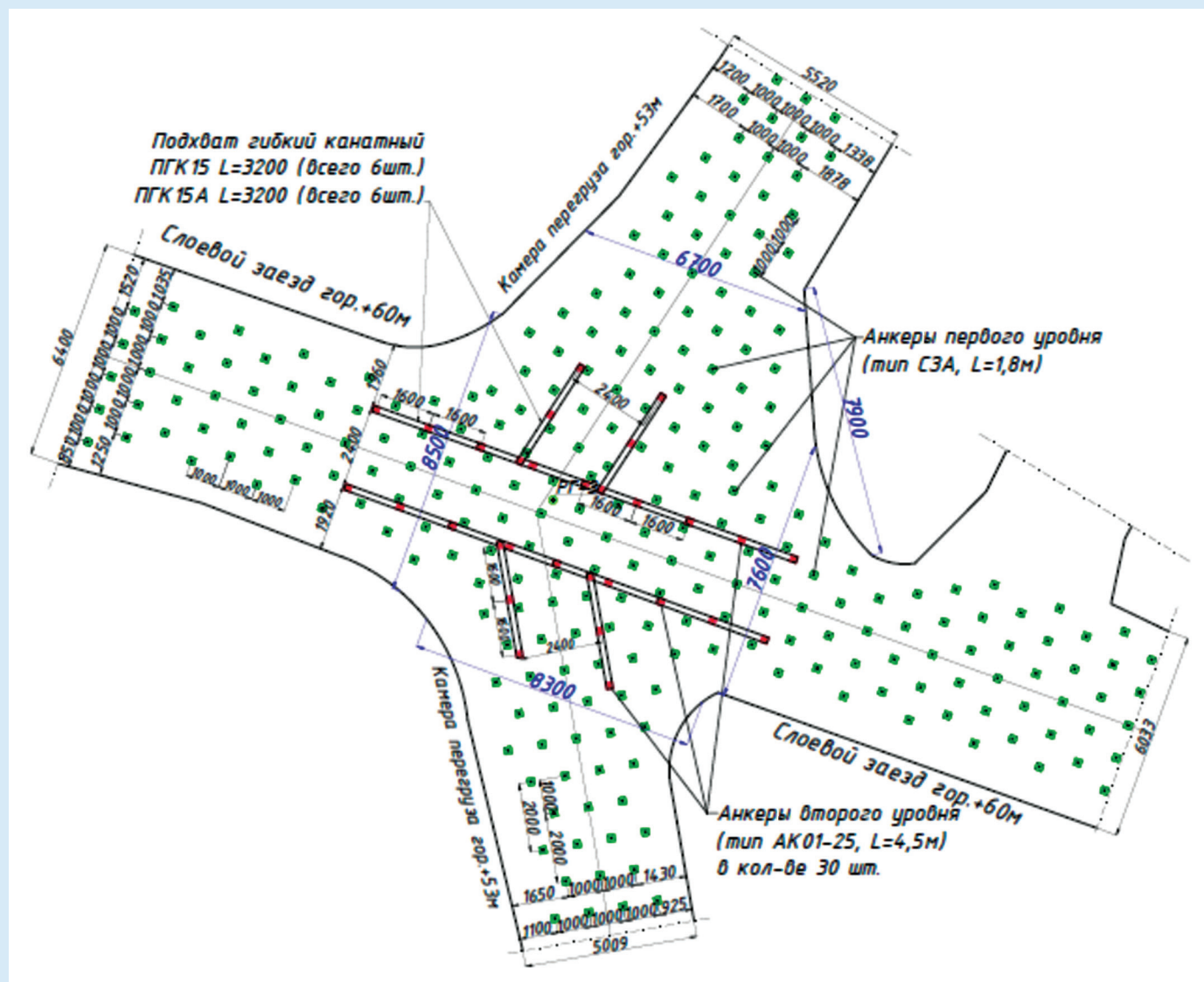
Рис. 3. Схема усиления крепи сопряжения многофункциональными канатными анкерами АК01-25.
